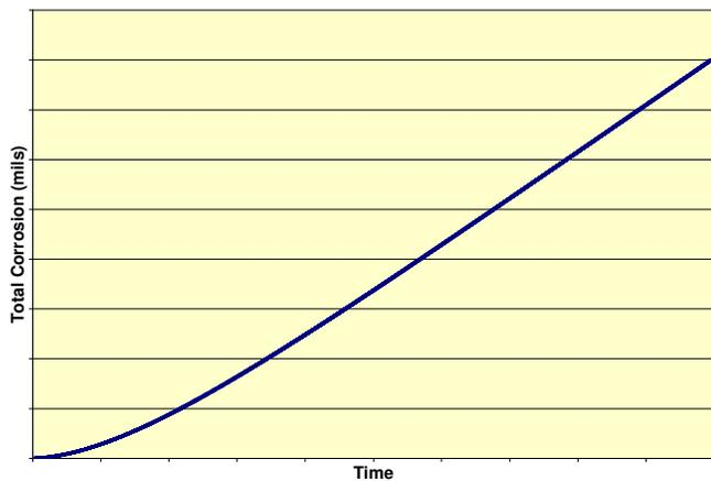
**FIGURE 13 – CUMULATIVE CORROSION VERSUS TIME FOR ASYMPTOTIC FOULING GROWTH**
