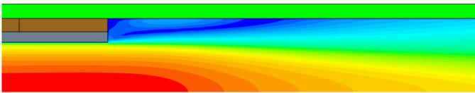
**FIGURE 5 – VELOCITY MAGNITUDES DOWNSTREAM FROM FERRULE TIP**
